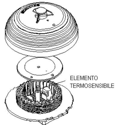
Ensamblar el sensor, montarlo sobre la base y accionar la función de "Mantenimiento Inmediato" como se describe en el manual de programación de la central.
