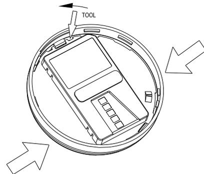
Quitar la cubierta, abrir la cámara del sensor y limpiar cuidadosamente.
