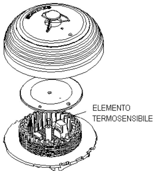
Riassemblare il rivelatore, montarlo sulla sua base ed eseguire la funzione di "Manutenzione Immediata" come descritto nel manuale programmazione della centrale.
